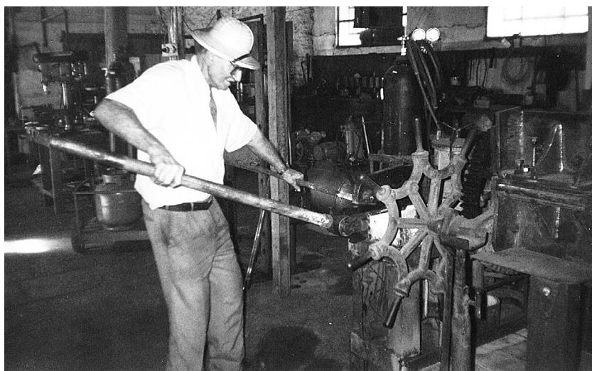
Sr. Andréa Selong utilizando uma gilhotina para cortar uma barra de ferro aquecido. Passo Fundo.
