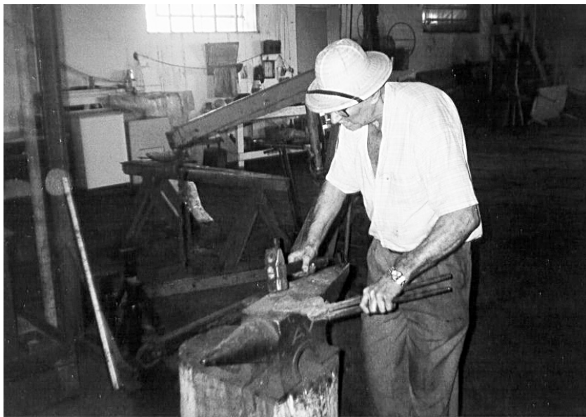
Sr. Andréa Selong marretando um machado sobre uma bigorna em sua ferraria. Passo Fundo.
