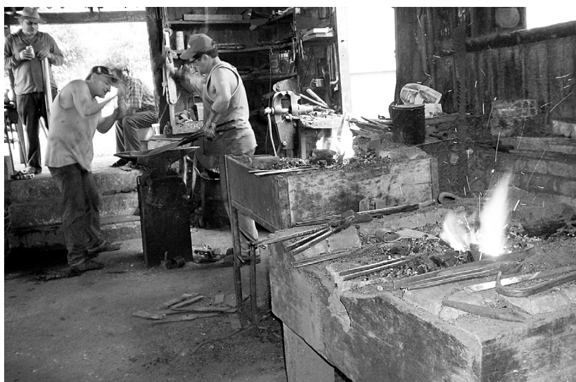
Mario e Celso Marina moldando uma pá de arado. À direita duas forjas com fogo. Guaporé.
